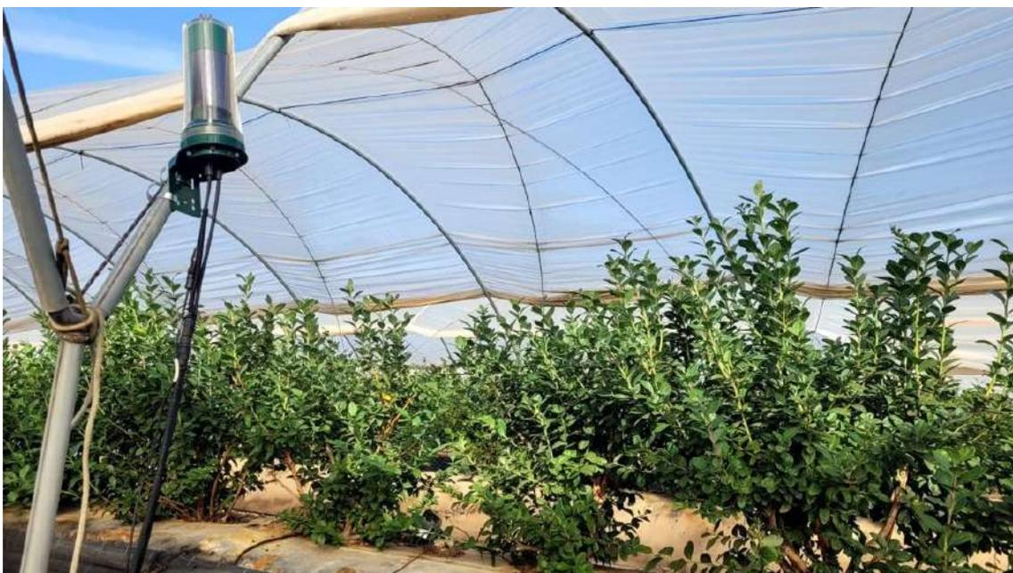
En todas nuestras fincas tenemos instaladas sondas de humedad y conductividad eléctrica, por cada diez hectáreas. Estas sondas, miden la conductividad, la humedad y temperatura a distintos niveles. Además, realizan la medición del caudal de agua, con lo cual controla y reduce el consumo de agua en fincas, para que este recurso se utilice de forma responsable.
